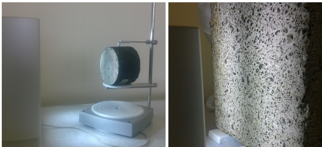
Figura 10 – Escaneamento de corpo de prova de asfalto cilíndrico e de placa de concreto.
